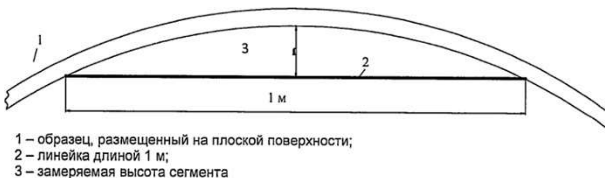
Рис.2. Пример измерения прямолинейности каната
